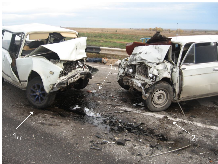
Рис. 2. Взаимное расположение транспортных средств и следов на месте ДТП
