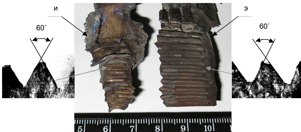
Рис. 4. Соединительная резьба боевой части взрывного устройства
