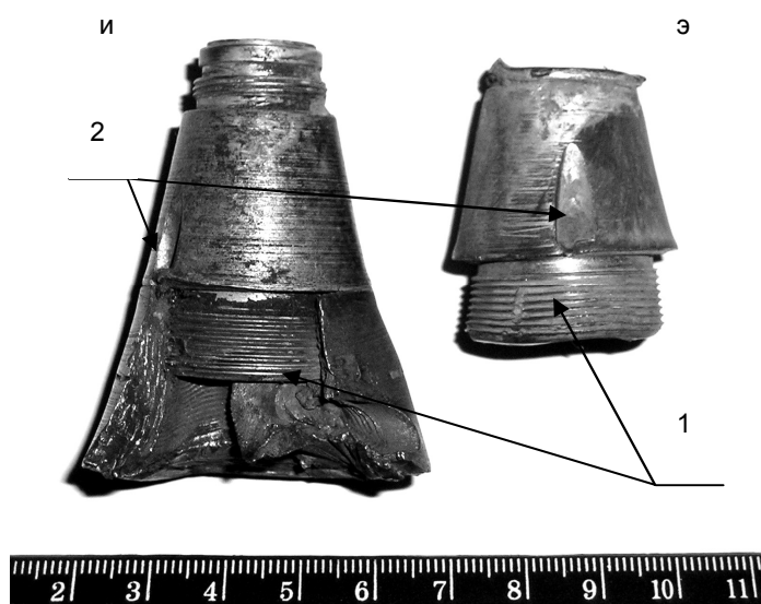
Рис. 2. Головная часть взрывателя
