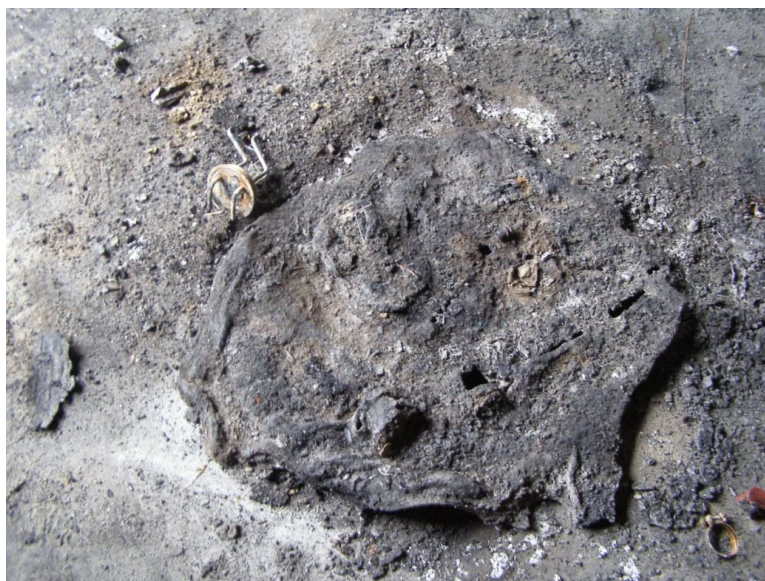
Рис. 3. Фрагмент полимерного топливного бака на полу гаражного бокса
