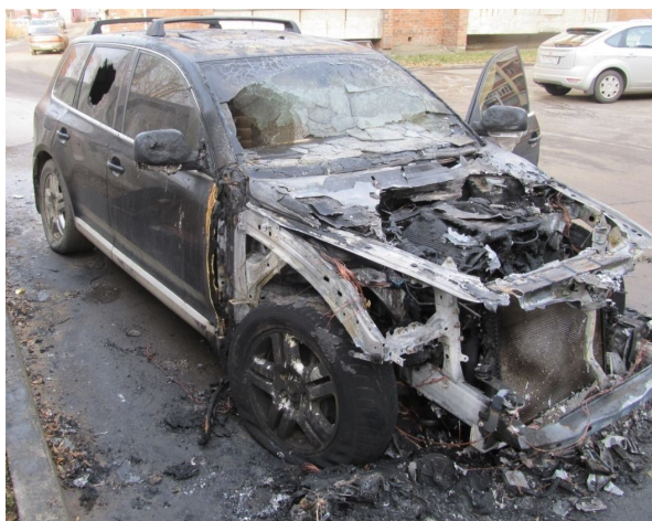
Рис. 1. Разрушение капота и крыльев автомобиля из сплава алюминия
