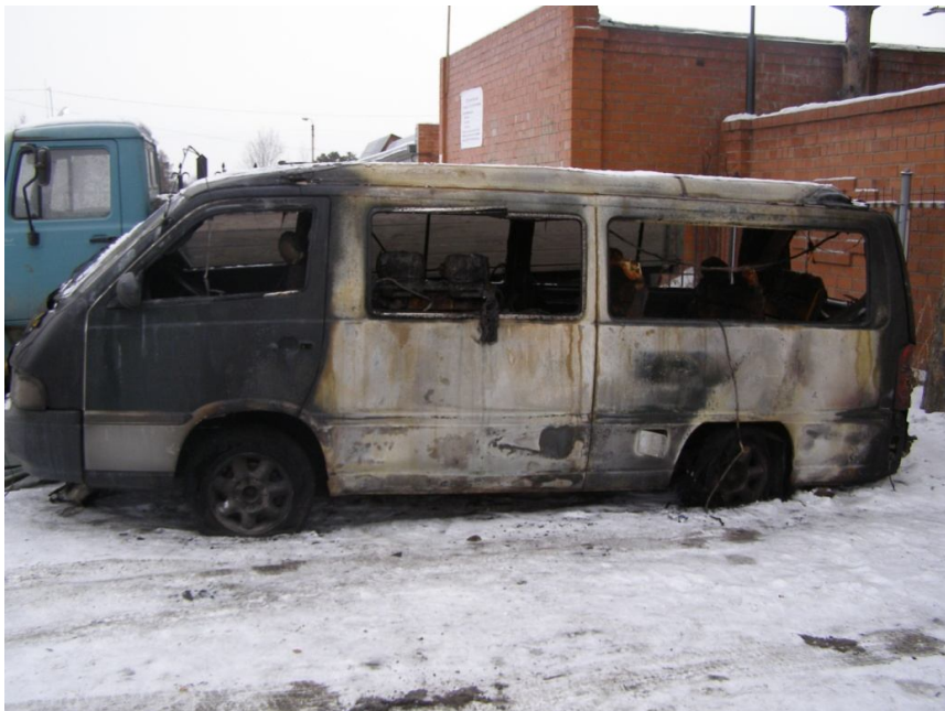
Рис. 2. Термические повреждения левого борта автомобиля SsangYong Istana
