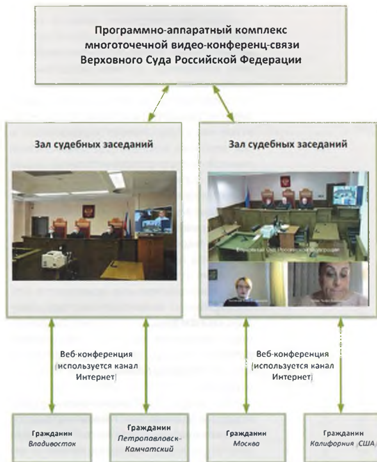
Рис. 3. Схема подключения веб-конференции с удаленными участниками
