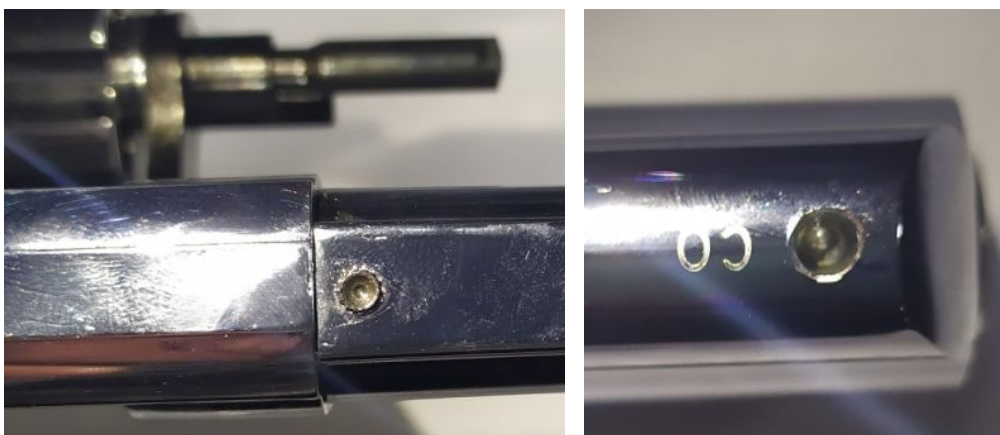
Рис. 8. Заглушенные отверстия в стволе в месте расположения штифтов
