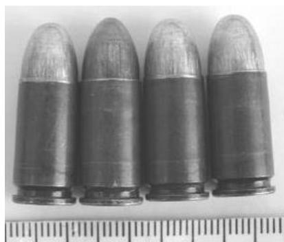
. 8. Патроны, изготовленные путем укорачивания гильзы военного патрона калибра 5,45x39 мм с монтажом пули калибра 9 мм патрона «Парабеллум»
