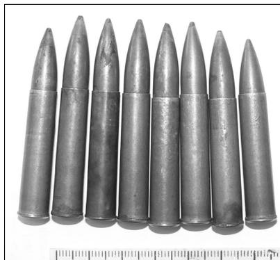
. 7. Патроны, изготовленные с использованием гильз патронов калибра 7,62 мм к револьверу «Наган» и пуль калибра 7,62 мм патронов к винтовкам Мосина образца 1891/30 гг.
