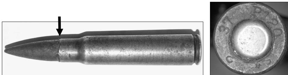
1. Винтовочный патрон калибра 7,92 мм к винтовкам «Маузер» с признаками самодельного снаряжения: а — наличие следов обжатия дульца; б — асимметричность положения капсюля
